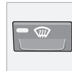
Para remover de forma rápida a condensação e o gelo do pára-brisas e dos vidros laterais. O ar flui para os vidros com elevada velocidade do ventilador. A lâmpada no botão do desembaciador fica acesa quando esta função está ligada.
