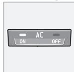
**ON:** O sistema de ar condicionado está ligado. O sistema é comandado automaticamente. Deste modo, o ar que entra é arrefecido e desumidificado.
