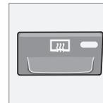
O aquecimento é utilizado para desembaciar ou eliminar gelo rapidamente do vidro traseiro e dos retrovisores exteriores. Pressionando uma vez o botão inicia-se simultaneamente o aquecimento do
