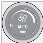
Rode o botão para aumentar ou diminuir a velocidade do ventilador. Se seleccionar **AUTO**, a velocidade do ventilador será comandada automaticamente. A velocidade do ventilador ajustada anteriormente é desligada.
