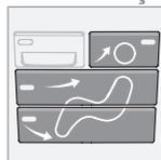
O fluxo de ar pode ser distribuído para os vidros, para as aberturas de ventilação no tablier ou para o chão, carregando-se nos botões de distribuição de ar.
